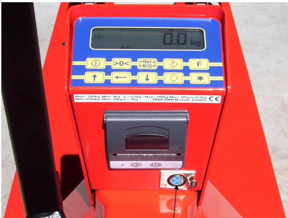
Prise pour raccordement chargeur
