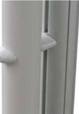
La traverse mobile de toise peut être serrée ou desserrée à l'aide du tournevis 2 mm dépendamment si l'utilisateur a besoin la traverse fixe ou la traverse automatiquement pliable vers le bas juste après l'utilisation.
