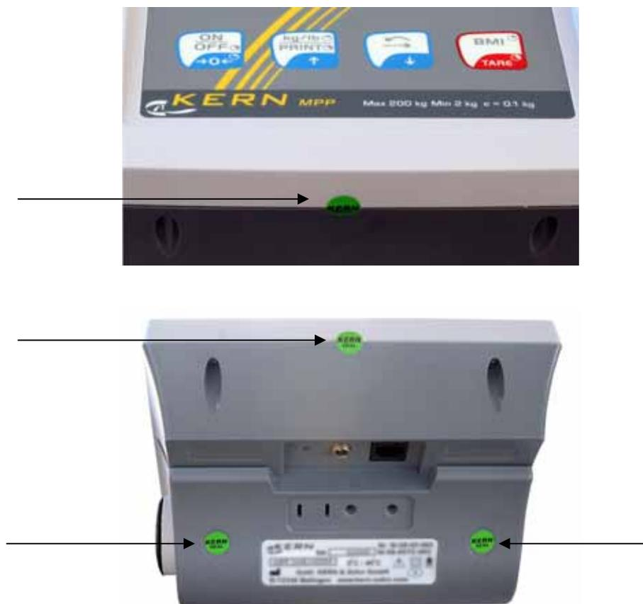
Sur les fauteuils de pèse-personne, la cellule de charge est protégée sur le dessous à l'aide du fil de sécurité avec plomb.
